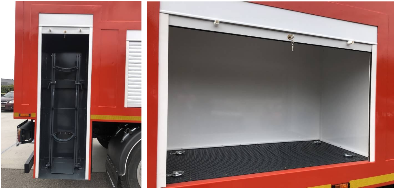
Фото – технологічні ніші під генератори, балони
